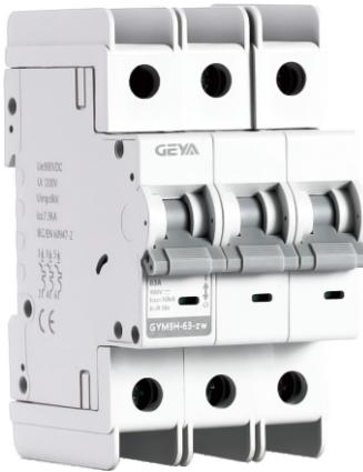
GYM9H-63-zw直流断路器适用于直流额定电压至1200V, 额定电流至63A的线路中, 作过载和短路保护之用, 也可以作为线路的不频繁操作转换之用。
